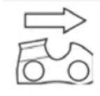
Freno a catena (il simbolo indica la posizione di rilascio del freno)
