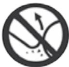
È necessario evitare il contatto della punta della barra di guida con qualsiasi oggetto.
