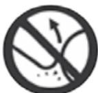
Contact van de punt van het zaagblad met enig voorwerp moet worden vermeden.
