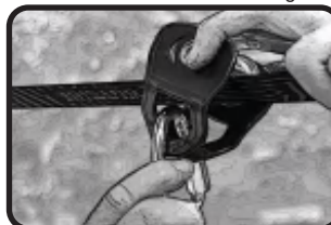
Karabiner an der Rolle befestigen
