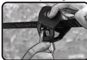
Fixez le mousqueton au galet
